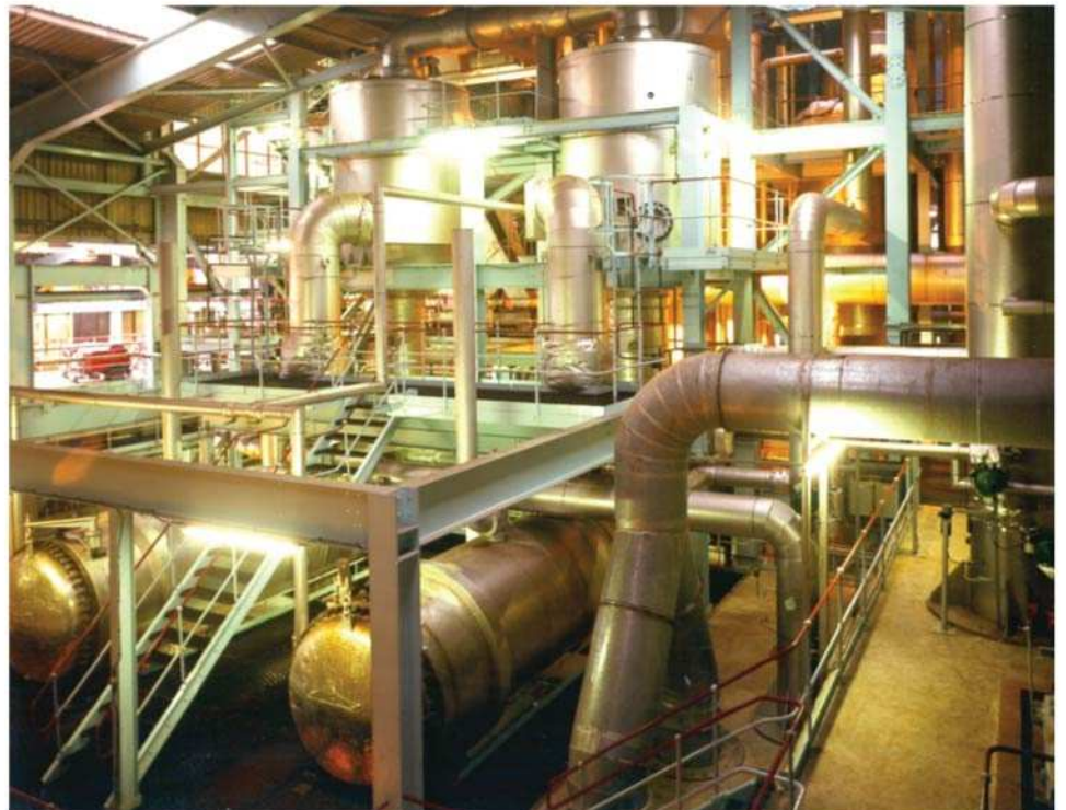
Рис. 5. 4-корпусная установка с аппаратами с падающей пленкой и с принудительной циркуляцией и с полным тепловым насосом для сгущения барды из под виски с производительностью 125 т/час, вариант В (технологическая схема - на рис. 6).
