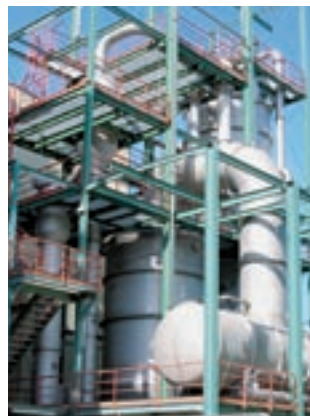
Fallstrom-Zwangsumlauf-Eindampfanlage, direkt beheizt mit Turbinenabdampf Verdampfleistung: 31.000 kg/h
