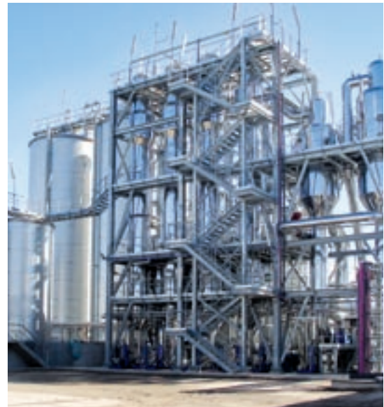
Sechsstufige Fallstrom-Zwangsumlauf-Eindampfanlage Verdampfleistung 31.000 kg/h
