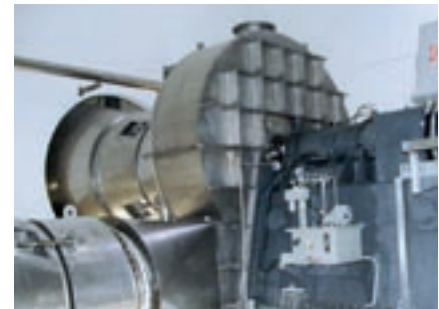
Hochleistungsventilator zur mechanischen Brüdenverdichtung
