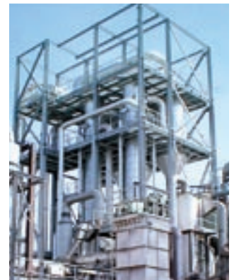
Zweistufige Zwangsumlauf- Eindampfanlage Verdampfleistung: 12.000 kg/h
