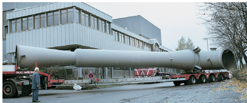
Strahlpumpe für eine 4-stufige Strahl-Vakuumpumpe zur Stahlgasung Saugstrom: 1.100 kg/h bzw. 1.387.000 m 3 /h, Saugdruck abs.: 0,6 mbar
