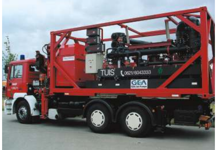
Unidad móvil de emergencia para la absorción de cloro
