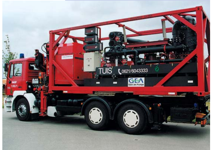
Mobiles Chlornotaggregat im Einsatz.
