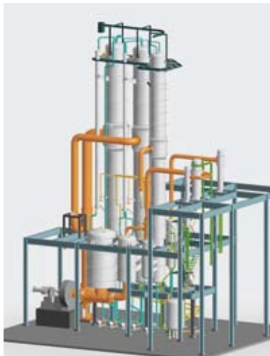
2-STUFIGE FALLSTROM-EINDAMPF-ANLAGE mit mechanischer Brüdenverdichtung und einstufigem Fallstromverdampfer (Finisher) mit thermischem Brüdenverdichter und Vakuumkühler für Glukose DE30 bis DE 55. Verdampfleistung: 49.300 kg/h.
