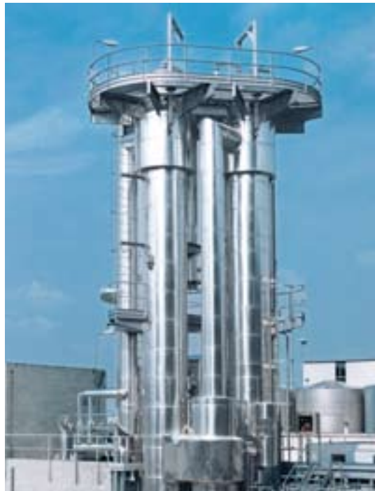
EINSTUFIGE FALLSTROM-EINDAMPF-ANLAGE mit zwei parallelen, mehrwegigen Heizkörpern für zwei verschiedene Stärkehydrolysate, beheizt über einen gemeinsamen mechanischen Brüdenverdichter. Verdampfleistung: 22.000 kg/h.
