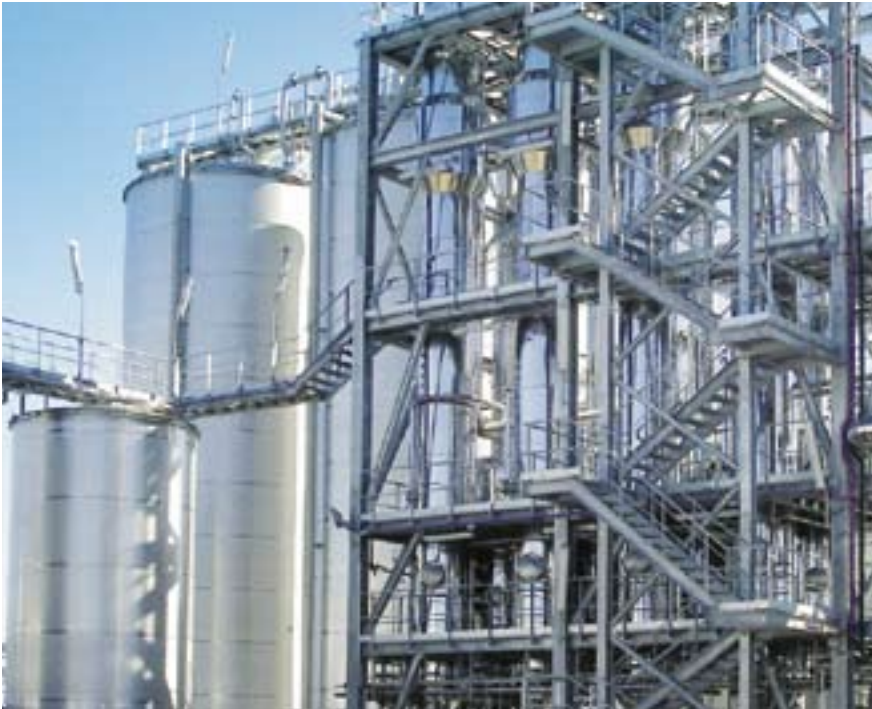
3-STUFIGE EINDAMPFANLAGE, direkt beheizt, in Gegenstrom- schaltung, mit nachgeschalte- tem Vakuumkühler zur Kon- zentrierung von Glukosesirup. Verdampfleistung: 25.000 kg/h
