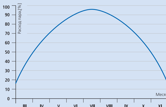
Рис. 18. Диаграмма потребления пара на основе соотношения, представленного в двух предыдущих диаграммах (рис 16 и 17). Среднее потребление пара 72 % от максимального.
