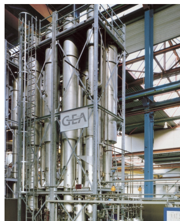
4-stufige Fallstromverdampfungsanlage mit Aromagewinnung für Apfelsaft, in Kompaktbauweise; Verdampfleistung: 8.000 kg/h
