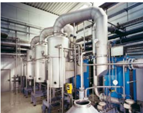
3-stufige Platten-Eindampfanlage, direkt beheizt; Verdampfleistung: 3.500 kg/h
