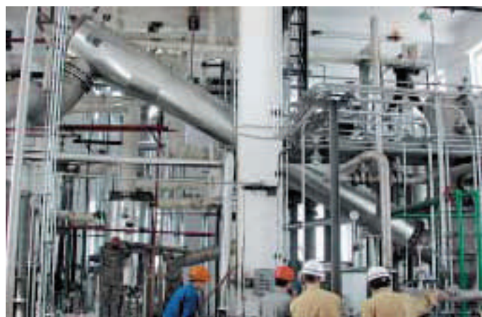
上图：世界最大聚酯生产装置使用的GEA Jet Pumps真空单元
