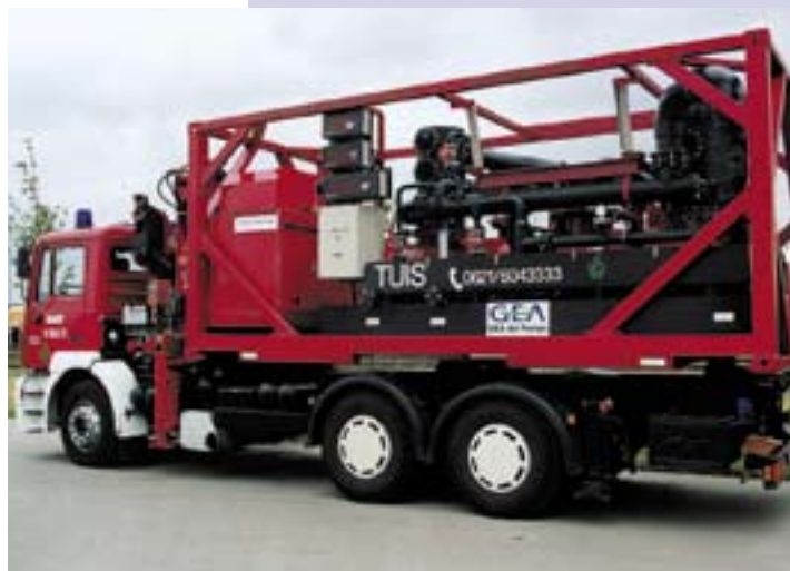
Мобильная установка аварийной абсорбции хлора за работой
