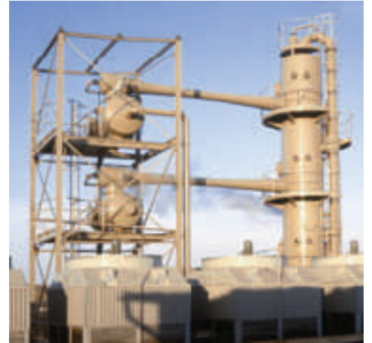
图9：桥式设计的3级蒸汽喷射制冷装置，可将194m 3 /hr水从28℃冷却至15℃。冷却能力：2900 kW
