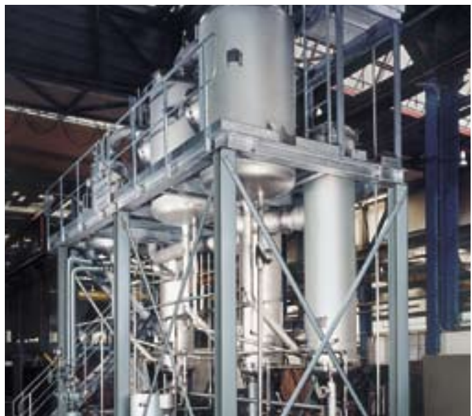
3-корпусной циркуляционный аппарат для выпаривания глициринового раствора. Производительность по выпаренной воде: 3 600 кг/час
