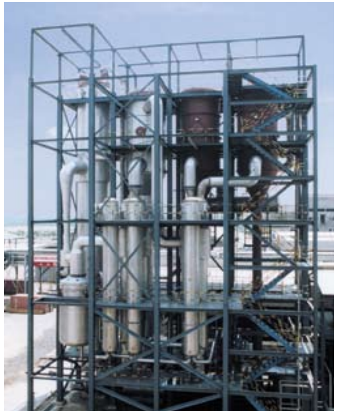
3-корпусная выпарная установка с падающей пленкой жидкости и принудительной циркуляцией с термическим компрессором вторичного пара для концентрирования сточных вод от производства глутамата натрия.
