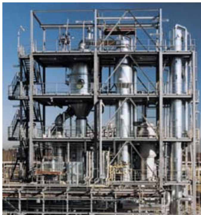
2-корпусная установка с падающей пленкой и с принудительной циркуляцией, работающая по противоточной схеме. Установка оборудована системой дистилляции для очистки конденсата вторичного пара от солей и органических соединений. Производительность: 9000 кг/час, концентрирование до 65 % с.в.
