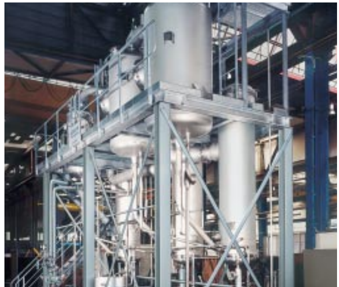
3-stufige Umlaufeindampfanlage für Glycerinwasser, Verdampfleistung: 3.600 kg/h
