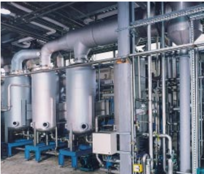
Mehrstufige Platten-Eindampfanlage für Fructose, Verdampfleistung: 16 t/h
