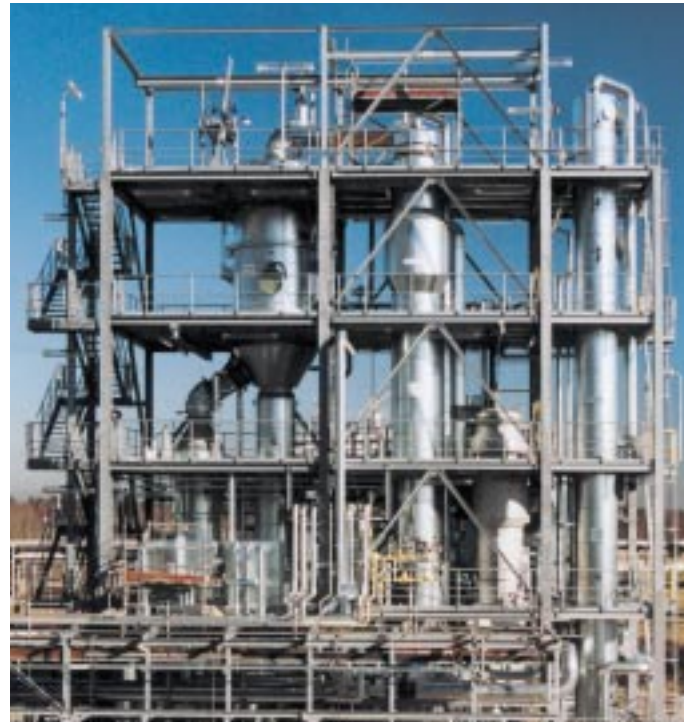
2-stufige Fallstrom-Zwangsumlauf-Eindampfanlage in Gegenstromschaltung mit nachgeschalteter destillativer Reinigung des Brüdenkondensates für salzhaltiges Abwasser. Verdampfleistung: 9.000 kg/h bei einer Konzentrierung auf 65 % TS
